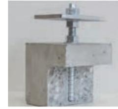
Le applicazioni possibili grazie al filetto metrico molto lungo sono numerose: regolare la planarità di una facciata architettonica fissandola a sbalzo sui solai, oppure registrare la distanza di un portapilastro da terra, fissare i golfari dei ponteggi alle colonne o ai solai in calcestruzzo.
